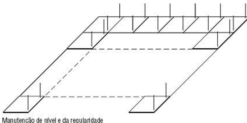
Nos forros com estrutura de sustentação, o encaixe das presilhas é feito nas ranhuras ou rebaixos, conforme o avanço da colocação.
