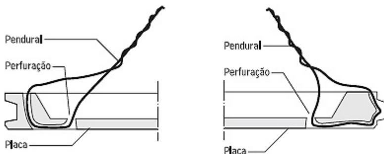
Para as placas consecutivas, da primeira fiada, em ambas as direções, recomenda-se a colocação de mais um ponto de fixação, para cada placa, a partir do encaixe tipo macho-e-fêmea unidos com a cola de gesso distribuída nas partes ou com o compósito fibroso na parte superior das placas.
