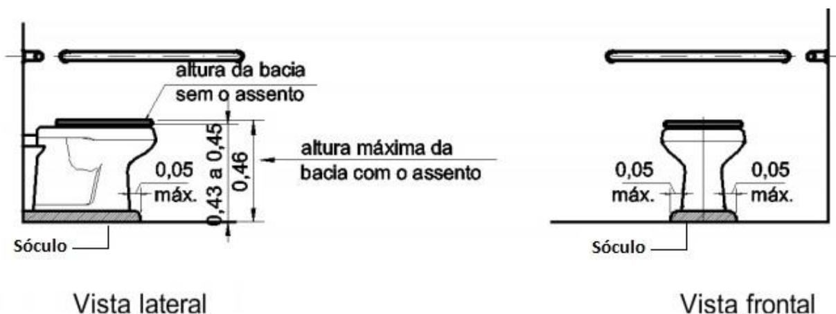
Os vasos ou bacias sanitárias são fabricados segundo as normas NBR 6498/83 e NBR 9338/86 da ABNT e devem ser obedecidas.
