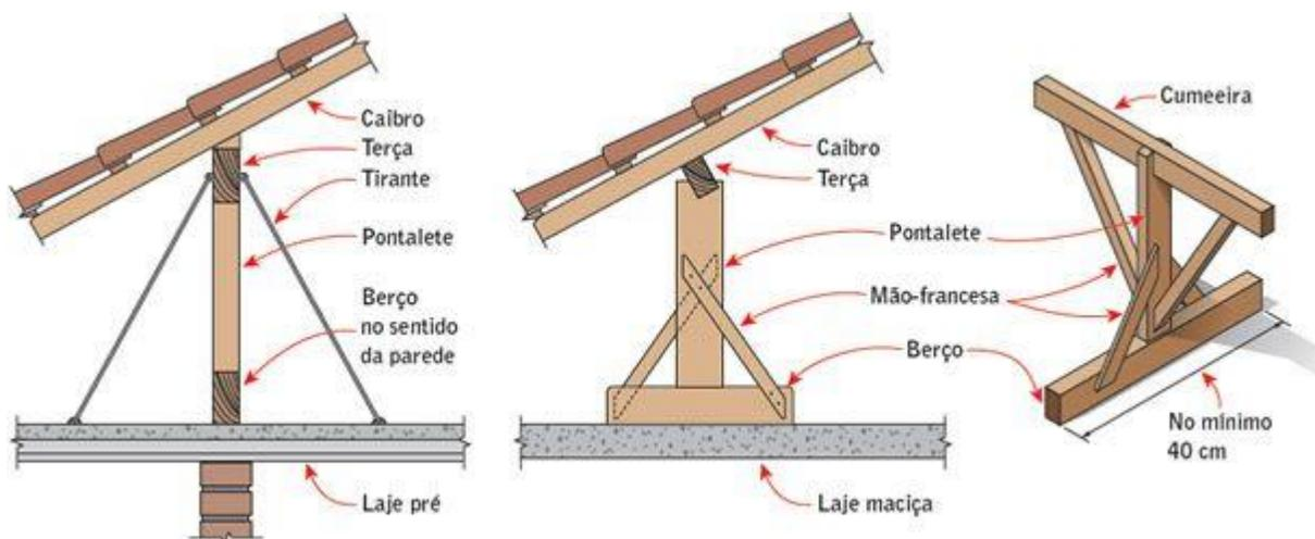
Os pontaletes poderão ser substituídos por bloco de concreto, tijolos cerâmicos ou Oitões.
