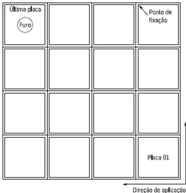
Após a fixação das placas à estrutura, é feita a manutenção dos bisotes entre placas, retirando o excesso de gesso proveniente do compósito fibroso.
