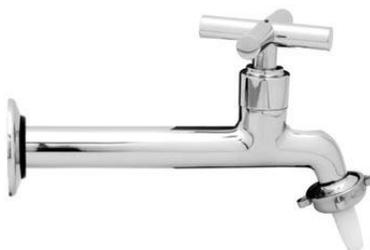
Torneira de pressão metálica para pia, longa, de parede é uma torneira de parede com 15 cm, sem rosca, para uso geral, com acabamento cromado, modelos para tubulações de 3/4" ou de 1/2" ou modelo para tubulação de 3/4", com luva de redução para 1/2", conforme o fabricante.
