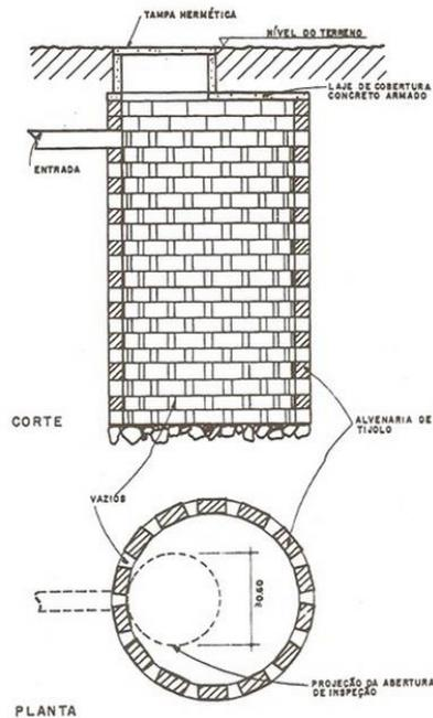
O sumidouro é um poço sem laje de fundo que permite a penetração do efluente do conjunto séptico no solo.
