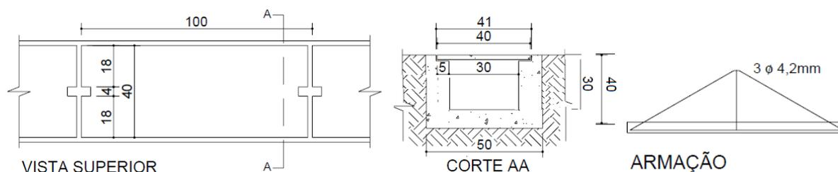
Para a construção da canaleta, o terreno de fundação deverá ser regularizado e apiolado manualmente.
